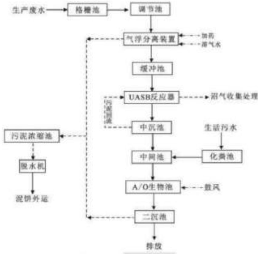
图 6.3-1 污水处理站工艺流程图
